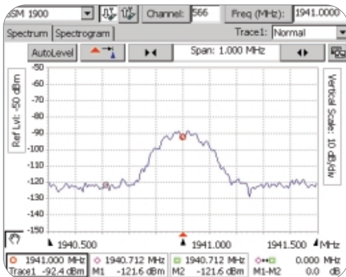
► Figure 21. A GSM cellular signal.
